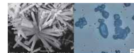
(a) エトリンガイト球晶 (b) スコロダイト結晶による砒素固定 結晶成長メカニズムを用いた結晶形態制御と不純物固定法の開発
