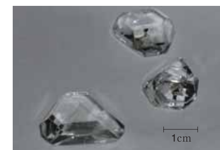
学生実験で作成したミョウバンの結晶
