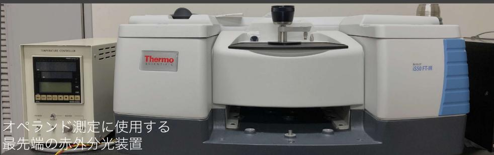
オペランド測定に使用する最先端の赤外分光装置
